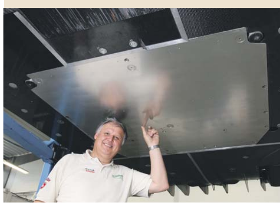
Energie geladen: Technikchef Kreyer zeigt die Batterie am Unterboden. Bei 80 Grad schaltet sie automatisch ab
